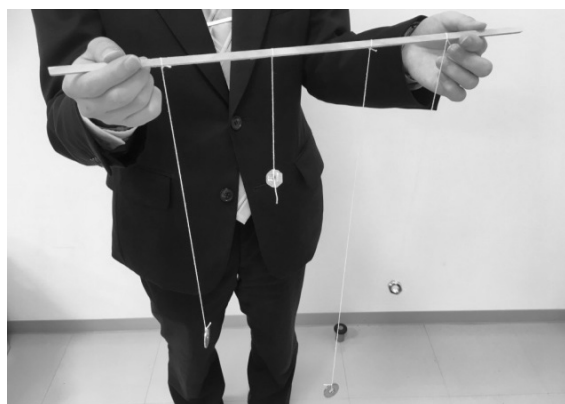
図1 4つのおもりを吊り下げた振り子の実験
